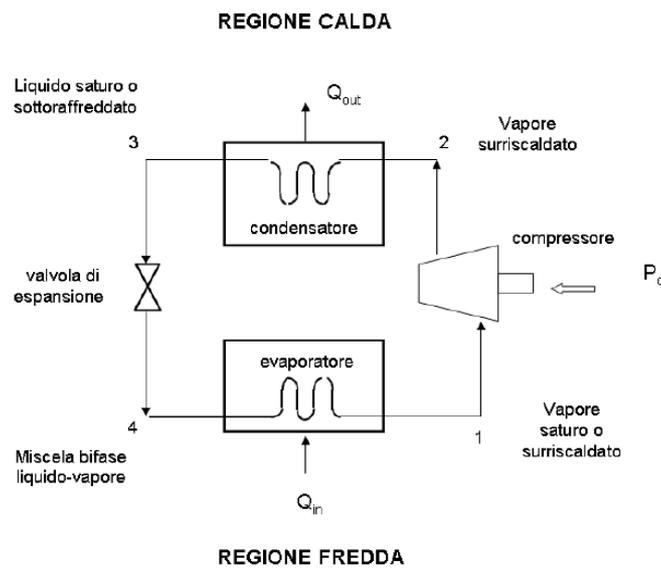
Le diverse fasi del ciclo termico di una pompa di calore si possono riassumere in 4 fasi elementari:
