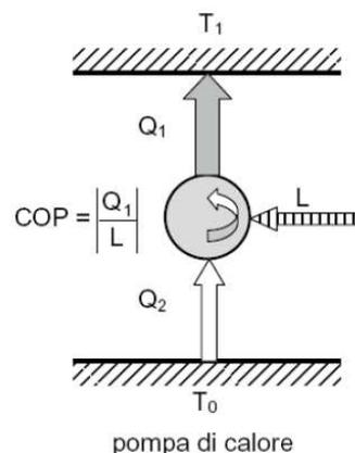
Il valore del rendimento energetico nominale di una pompa di calore (COP) può pertanto variare, a seconda della tipologia di apparecchiatura, indicativamente da 2,8-3,8 di una pompa di calore aria/acqua a valori di 3,5-4,8 di una pompa di calore acqua di falda/acqua.
