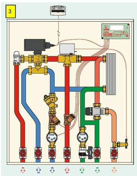
*Tipologie di satelliti di utenza: n. 1 – solo riscaldamento con regolazione mediante valvola a 3 vie;
