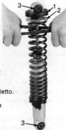
Fig. 39 - 1) Gomma di protezione 2) Ghiera
