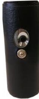
Il calibratore è un **generatore di un suono di calibrazione**. Emette un tono puro con una frequenza di 1000 Hz con pressione RMS di 1Pa. Viene collegato mediante un adattatore al fonometro. La misura da questo rilevata è di 94 dB.
