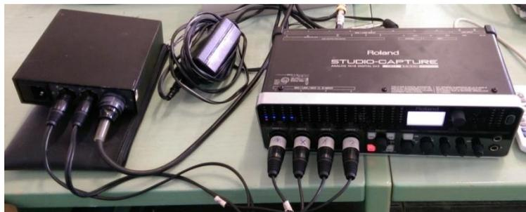
Il microfono Soundfield consente misurazioni simultanee di pressione unidirezionale e delle tre componenti cartesiane di velocità delle particelle. Con questo metodo risulta possibile posizionare il microfono nello spazio e studiarne il campo acustico con le sue componenti.
