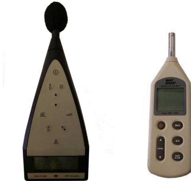
Il fonometro misura il **livello del valore quadratico medio della pressione sonora ( $L_p$ )** espresso in **dB**.
