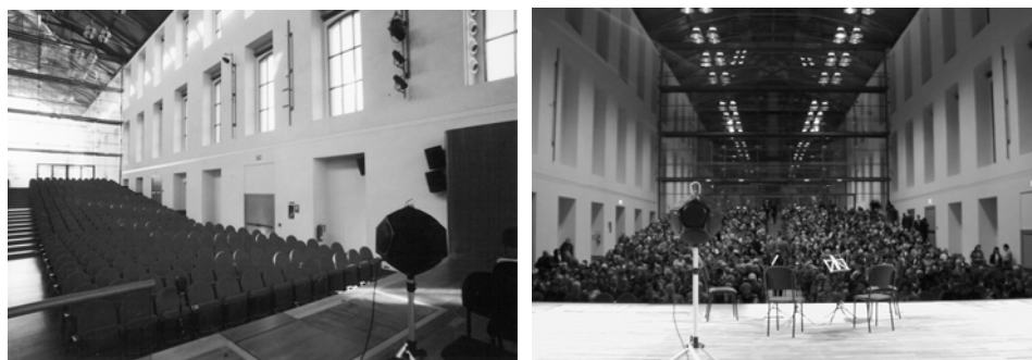
Fig. 9.3.1 l'Auditorium Paganini di Parma: misure a sala vuota (a) e piena (b). Si notino i microfoni in prima fila
