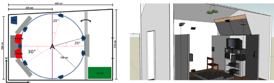
Figura 8 – A sinistra: Layout planare Ambisonic, evidenziando sorgenti (in blu); a destra: Layout 3D previsto per sviluppi futuri.
