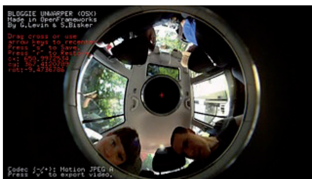
(a) Fig. 6 - Immagine dalla telecamera IP prima (a) e dopo (b) l'elaborazione di unwrapping .
